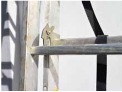
FALSCH Die Spreizsicherung wurde nicht genutzt.
