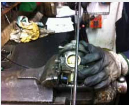
Der Vergaser wird zerschnitten,
